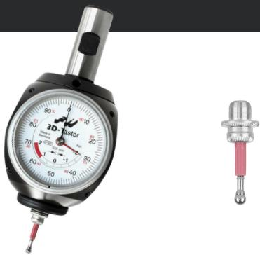
Modèle : palpeur 3D universel précis pour montage dans la broche fraiseuse, ou la tête de fraisage. Changement de touche sans outil. Sécurité accrue grâce à la course de dépassement plus longue et au point de rupture dans le palpeur. Ø queue : 20 mm. Livré avec touche Ø 4mm.
