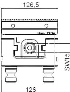
Montage sur point zéro avec entraxe de 96. Rails latéraux pour fixation sans point zéro. Livré avec une clé allen de 5 mm et 4 pions de centrage.
