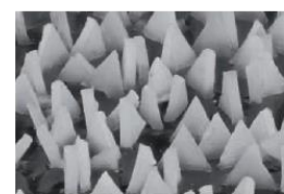
Orientation optimale du grain abrasif VICTO GRAIN
