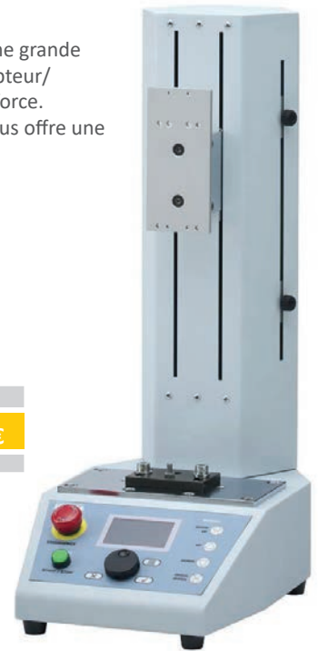
Utilisation avec dynamomètre ZTA et table pour tests de pelage
